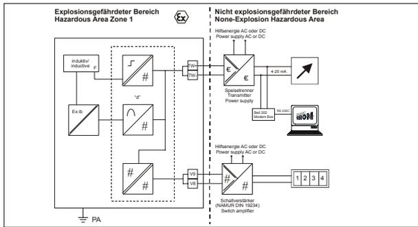
**DE Sicherheits-technische Daten: Magnetisch-induktive Durchflussmesser, Modell DT47..**
