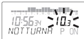
Premere il tasto **E** entro 2 minuti per confermare la temperatura COMFORT e selezionare la temperatura NOTTURNA, altrimenti si torna alla visualizzazione esecutiva e i dati vengono automaticamente memorizzati.
